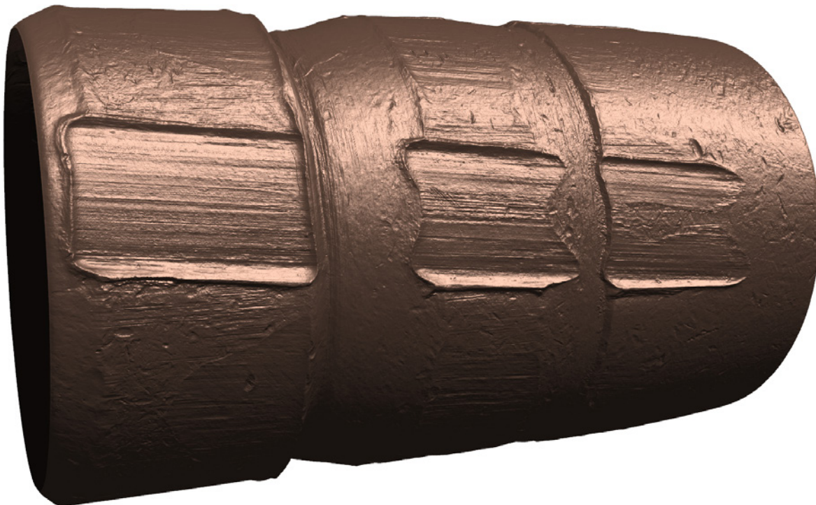
Geschosse des Kalibers 9.3x74mmR, in 3D gescannt.
