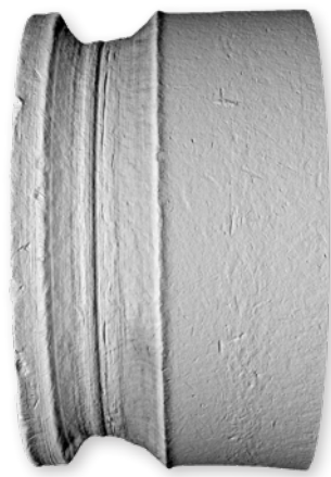
9 mm povrch nábojnice 1 FOV ráfek. Šířka pruhu: 5,8 mm Doba skenování: 9 min Velikost souboru: 82 MB.
