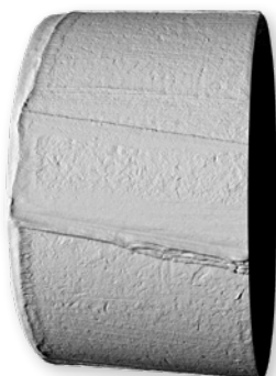
Povrch střely kalibru 9 mm. Šířka pruhu: 5,8 mm Doba skenování: 3:15 min Velikost souboru: 72 MB
