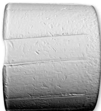
Povrch střely kalibru .45. Šířka pruhu: 8,99 mm Doba skenování: 9:15 min Velikost souboru: 138 MB
