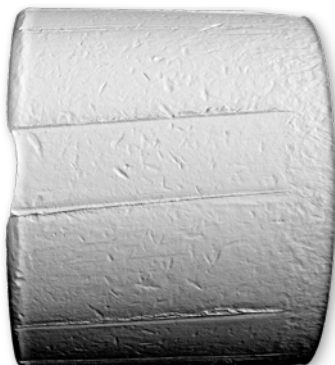
.45 Geschossoberfläche. Streifenbreite: 8,99 mm Scanzeit: 9:15 min Dateigröße: 138 MB
