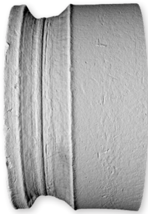
9 mm Mantelfläche der Hülse - Breite: 1 Sichtfeld. Streifenbreite: 5,8 mm Scanzeit: 9 min, Dateigröße: 82 MB
