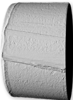
9 mm Geschossoberfläche. Streifenbreite: 5,8 mm Scanzeit: 3:15 min Dateigröße: 72 MB
